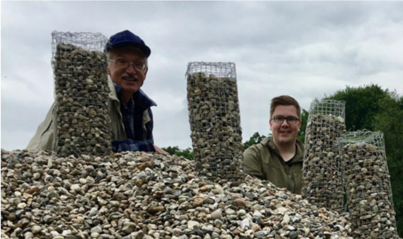
Wir experimentieren mit aufrecht eingebrachten Gitterzylindern, gefüllt mit Kies und Holz.
