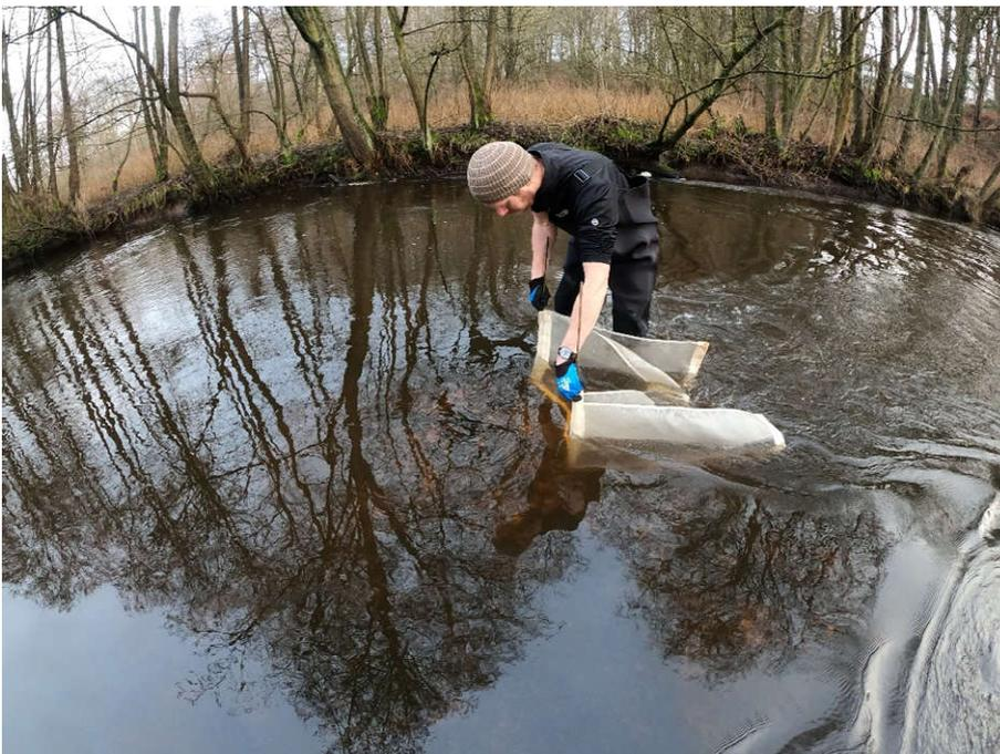
**Abbildung 8:** Positionierung des Auffangnetzes stromab eines simulierten Laichbettes
