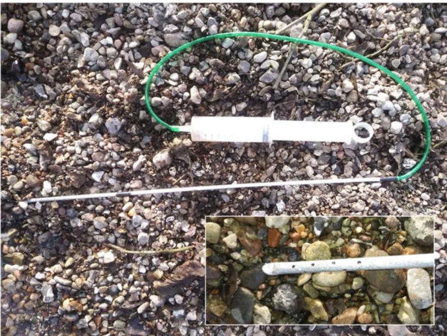
**Abbildung 5:** Vorrichtung zur Entnahme von Interstitialwasser, Detail: Spitze des Aluminiumrohres mit Bohrungen
